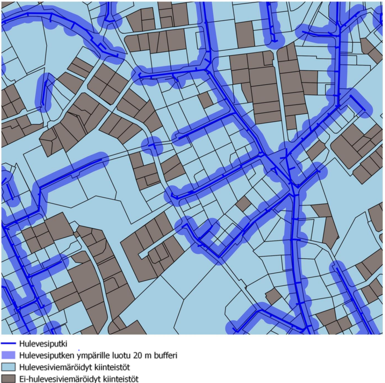
Kuva 12. Hulevesiviemäröidyt kiinteistöt huleveden viemäröintialueella (Nyökkiö, Espoo)
