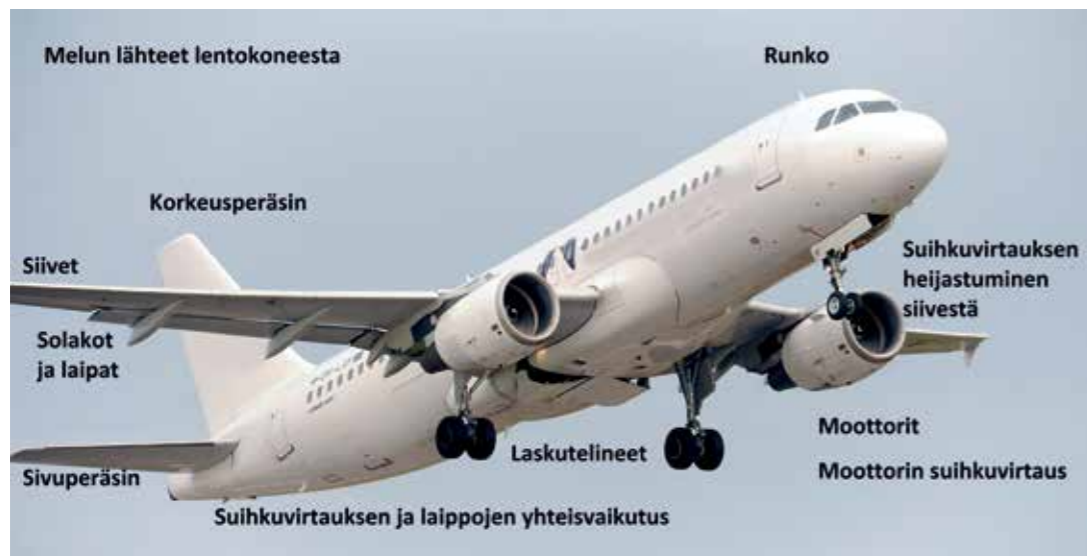
Kuva 28. Lentokoneen melu muodostuu useiden tekijöiden yhteisvaikutuksena
